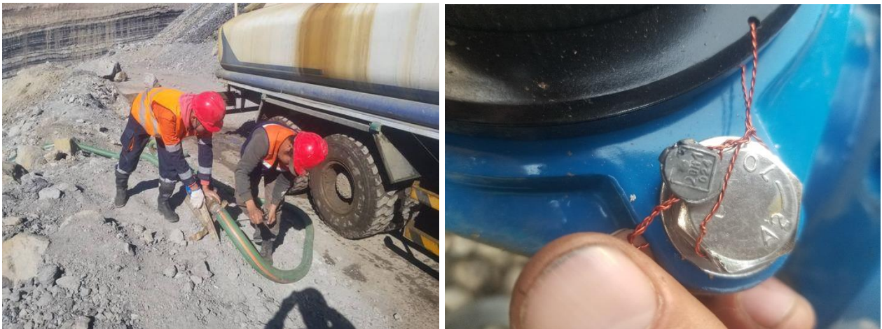
Зураг №6 Тоолуур суурилуулсан байдал
