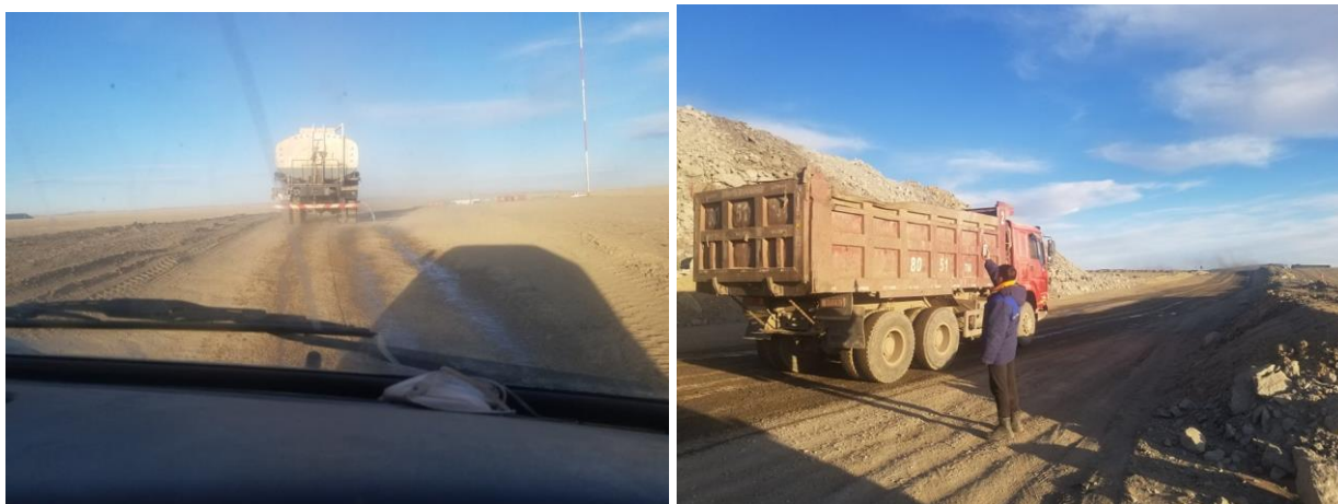
Зураг № 36 Тоосжилт бууруулах усалгаа Зураг №37 Усалгааны дараах тоосны хэмжилт хийж байгаа нь
