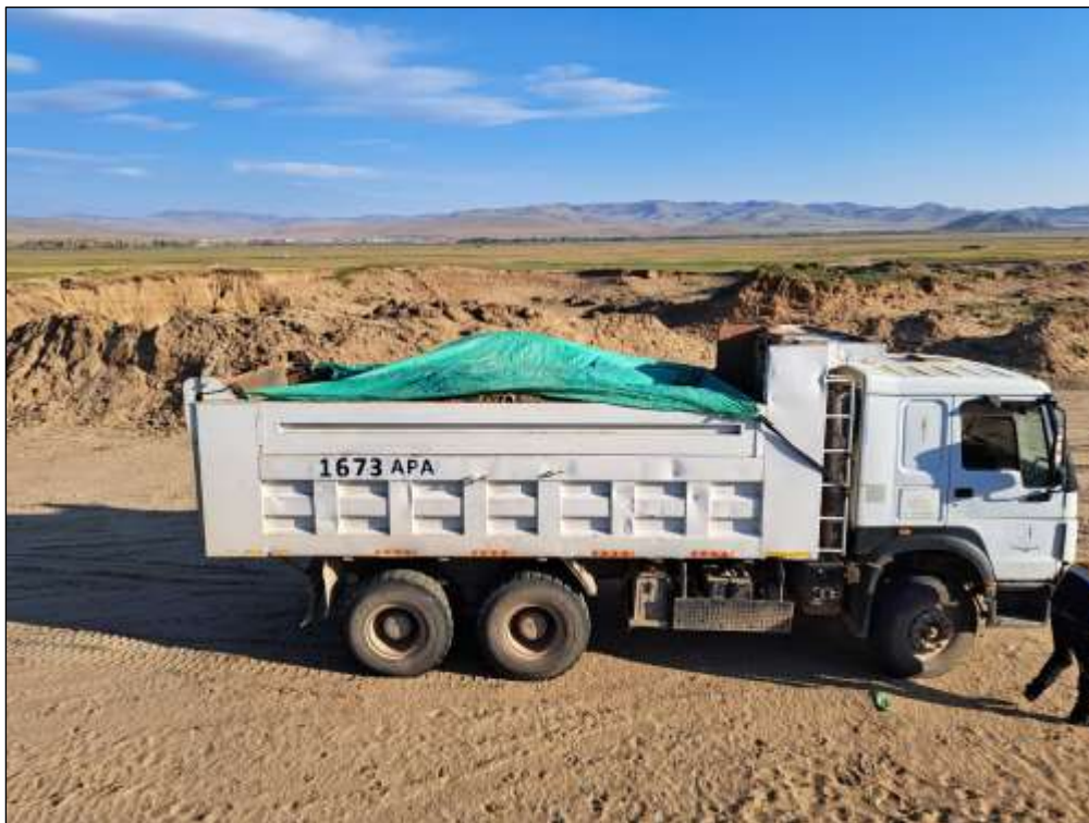
Зураг №11. Тоосжилтыг бууруулах зорилгоор элс тээврийн машины ачаанд хучилт хийж буй байдал
