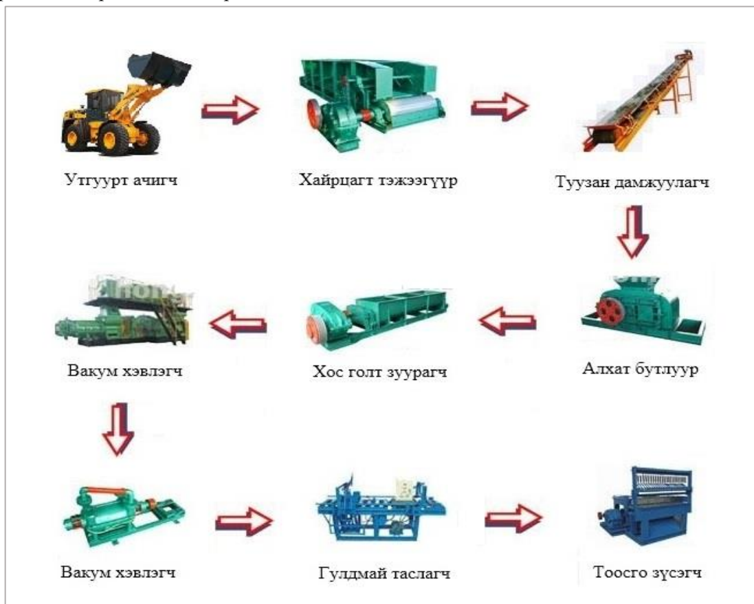
Зураг 2. Тоосго үйлдвэрлэлийн тоног төхөөрөмжийн дамжлага схем
