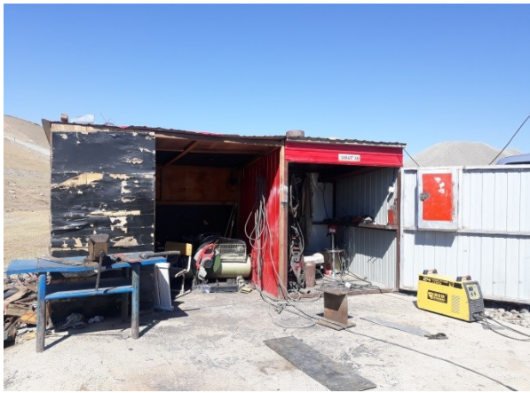
Зураг 7. Засварын газрын талбайн хөрс бохирдохоос сэргийлж бетондсон байдал
