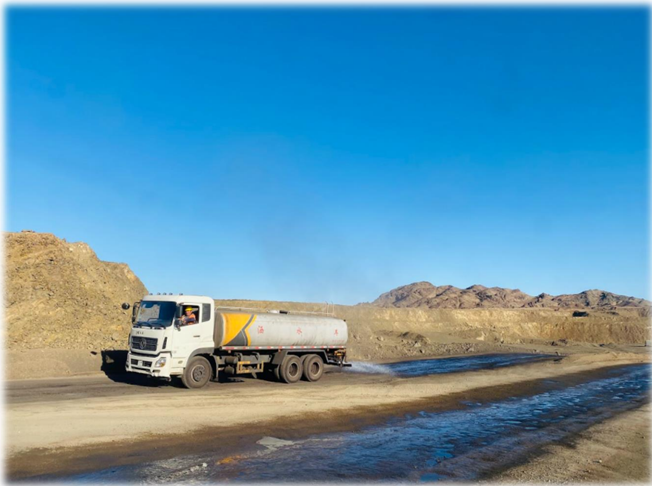
Зураг 4. “20 тоннын цистерн”-ээр уурхайн технологийн замыг усалж буй байдал.
