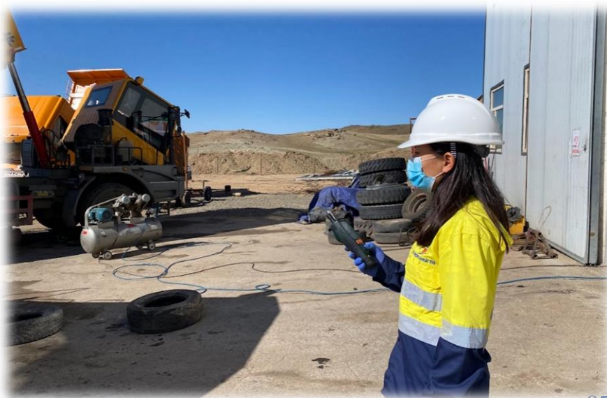
Зураг 43. EXTECH VPC-300 гар багажаар хэмжилт хийж байгаа байдал.
