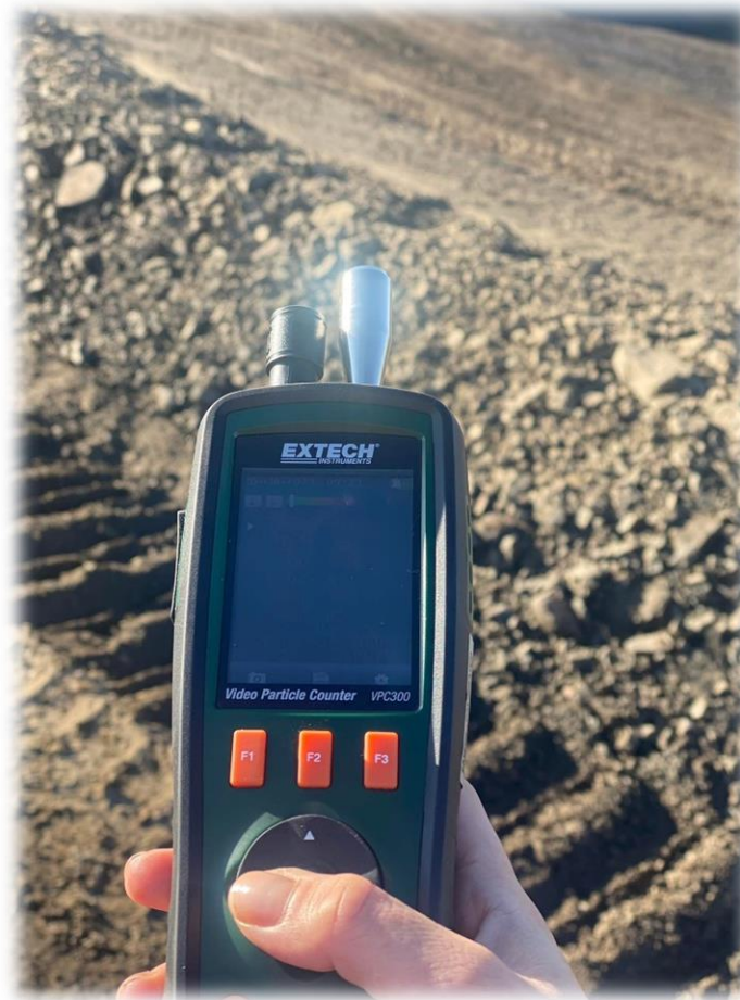
Зураг 43. EXTECH VPC-300 гар багажаар хэмжилт хийж байгаа байдал.
