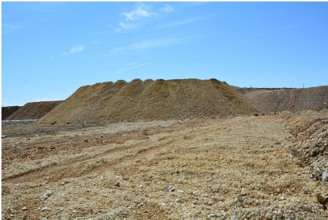
Уусгалт хийх талбай бэлтгэн, хүдэр асгасан байдал
