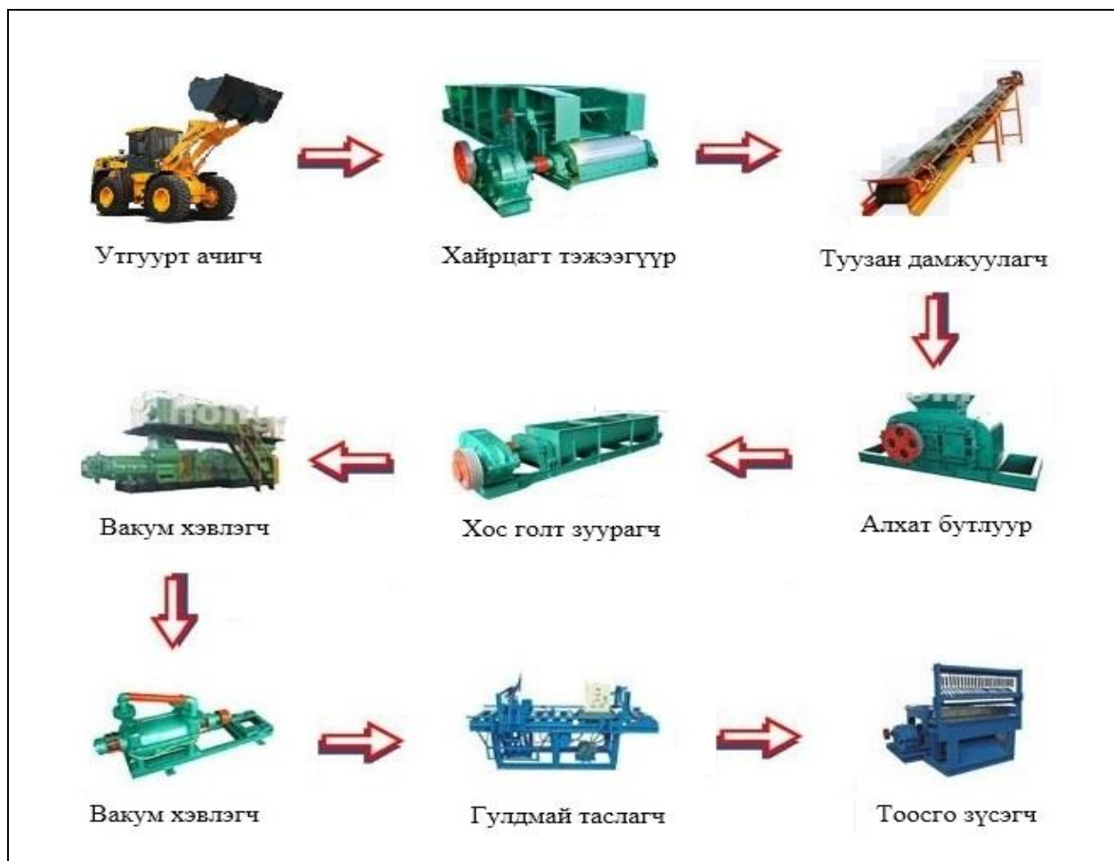
Зураг 3. Тоосго үйлдвэрлэлийн тоног төхөөрөмжийн дамжлага схем
