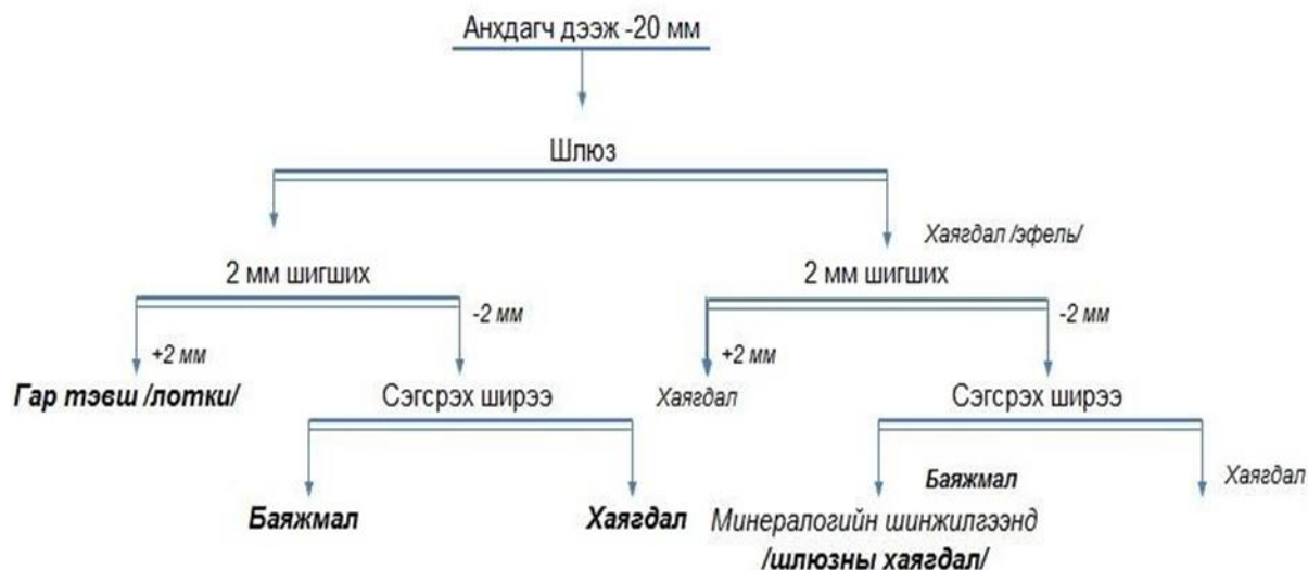
Зураг -6. Дээжийг шлюз ба сэгсрэх ширээгээр баяжуулсан туршилтын бүдүүвч
