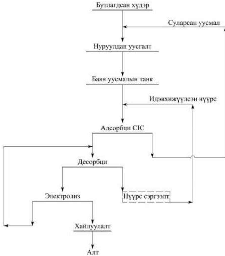
Зураг 6 Нуруулдан уусгалт-СІС үйлдвэрийн технологийн схем
