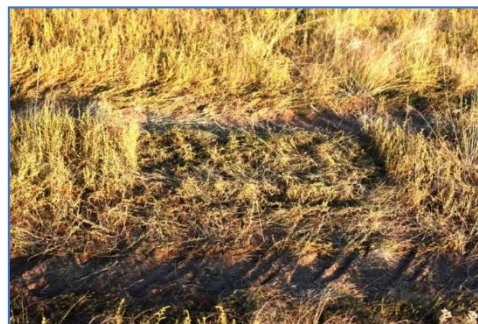
Зураг 1. 6. Вибраторийн машин уян харимхай долгион үүсгэсний дараа
