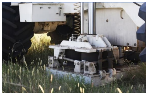
Зураг 1. 5. Вибраторийн машин уян харимхай долгион үүсгэж буй нь
