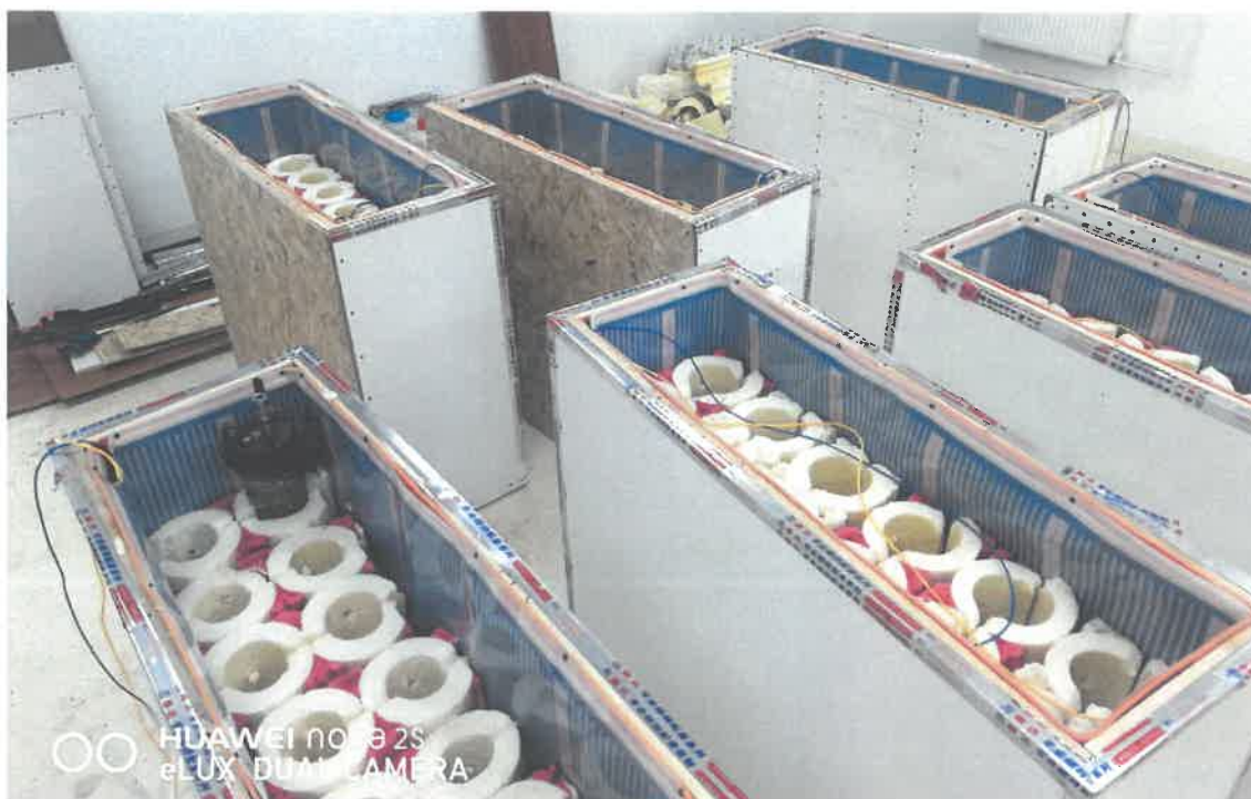
Зураг 5. “Тэлмэн Ресурс” ХХК-ийн угсарсан лабораторын зориулалттай ашиглах тус бүр нь 14 ш бортого агуулах хүчин чадалтай хөөсөн ванн
