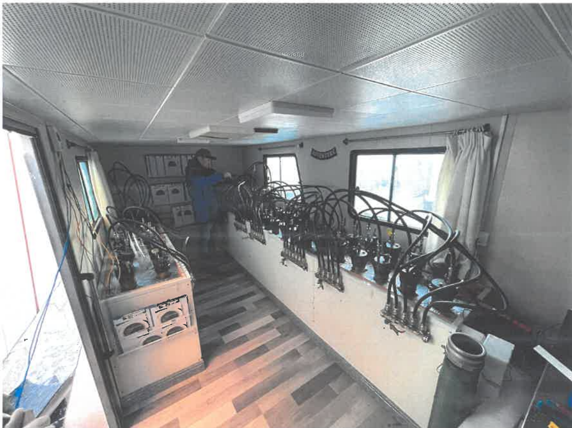
Зураг 8. Хөдөлгөөнт лабораторид 5 ширхэг дээж хадгалах дулаан баригч хөөсөн ванн суурилагдсан ба HQ бортого 46 ширхэг, PQ бортого 10 ширхэг, дээжний бичиглэл хийх болон хэмжилт хийх цилиндрууд, жин хэмжүүр бусад багаж хэрэгслүүд суурилагдсан.
