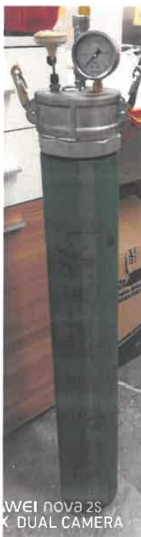
Зураг 4. Тэлмэн Ресурс ХХК-ийн угсарсан PQ хэмжээтэй лабораторын зориулалттай ашиглах бортого
