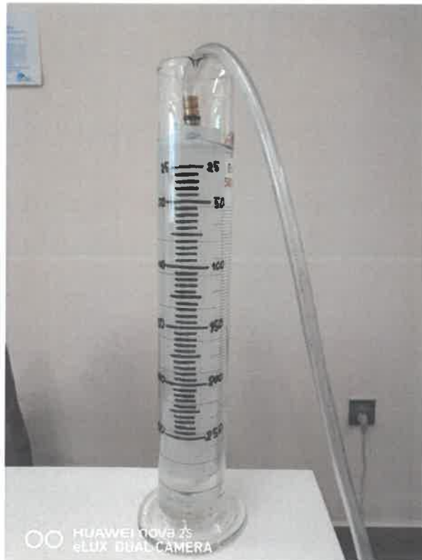
Зураг 6. Нүүрсний хийн эзлэхүүн хэмжигч 250 мл-ийн цилиндр болон агуулагч шилэн цилиндрээс бүрдсэн багаж
