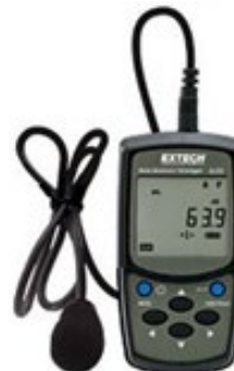
Фото зураг 2. EXTECH Noise Dosimeter, Datalogger, and Sound Level Meter SL355 загварын зөөврийн багаж
