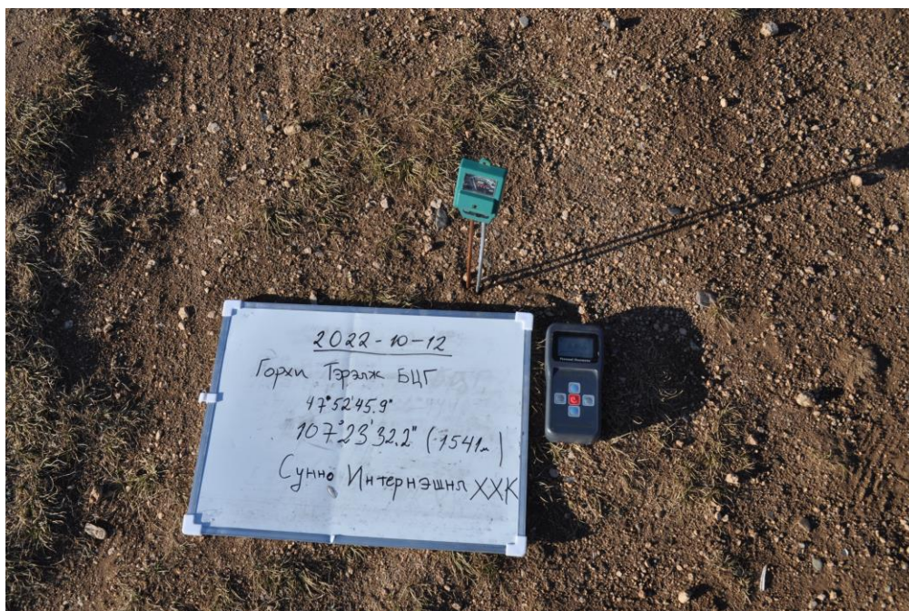
Зураг.18. Талбай дахь дозиметрын хэмжилт
