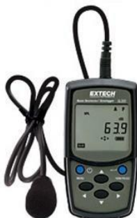
Фото зураг 3-1. EXTECH Noise Dosimeter, Datalogger, and Sound Level Meter SL355 загварын зөөврийн багаж
