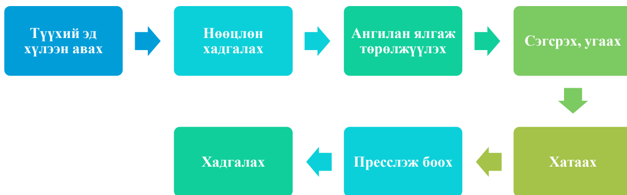
Зураг 3. Ноолуурын үйлдвэрийн технологийн схем
