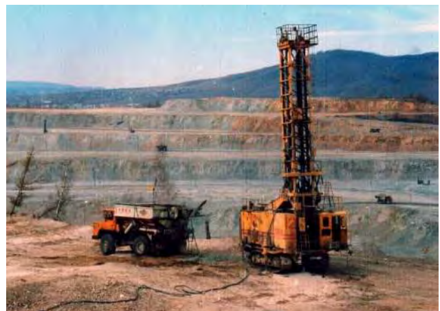
Зураг 29. Өрмийн машин болон өрөмдлөг хийж буй явц
