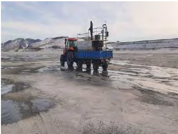
РВ-80100 тоног төхөөрөмжөөр кальцийн хлорид цацаж байгаа байдал
