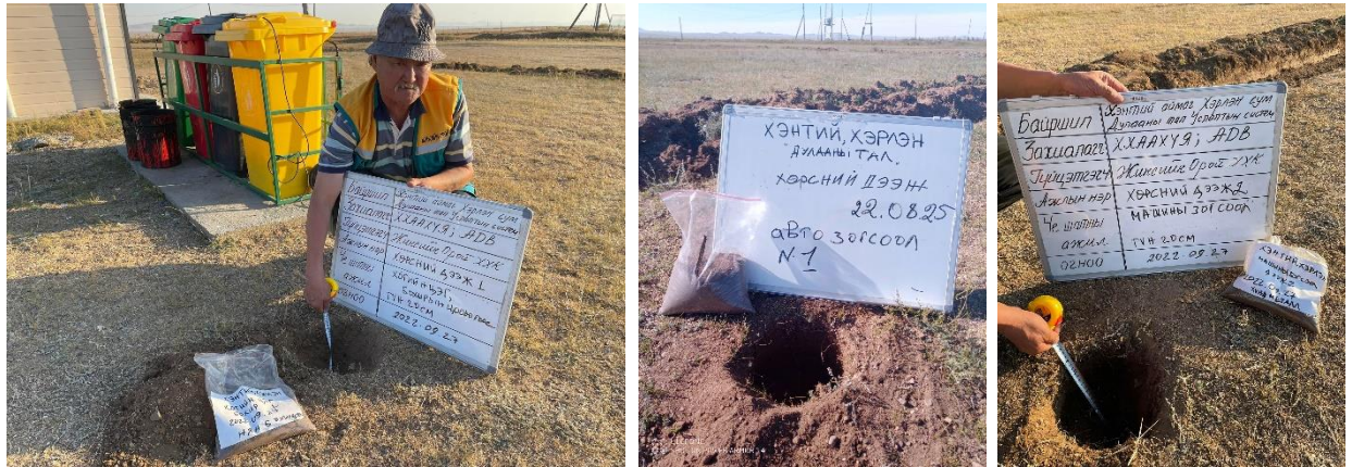
Зураг 42. Хөрсний зүсэлт хийж, дээж авч буй байдал
