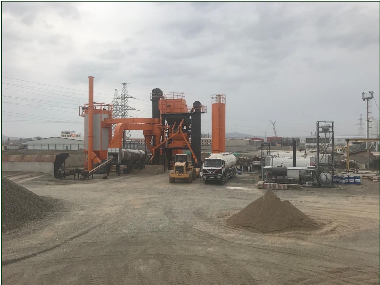
Зураг 2. Асфальтбетон хольц үйлдвэрлэлийн хэсэг буюу суурин тоног төхөөрөмжийн харагдах байдал
