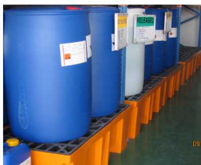
Зураг 25. Шингэн бодис асгарсан тохиолдолд хурааж авах суурь сав, шингээгч материал
