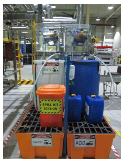
Зураг 25. Шингэн бодис асгарсан тохиолдолд хурааж авах суурь сав, шингээгч материал
