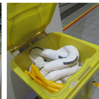
Зураг 25. Шингэн бодис асгарсан тохиолдолд хурааж авах суурь сав, шингээгч материал
