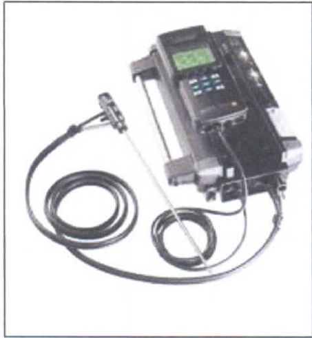
ДЦС-3 ТӨХК-ийн ДДХ-ийн яндангаар хаягдах утааны хийн хяналтын зөөврийн төхөөрөмж TESTO-350
