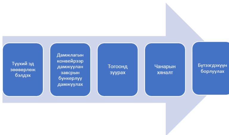
Зураг 1-4. Бетон зуурмагийн үйлдвэрийн технологийн бүтэц
