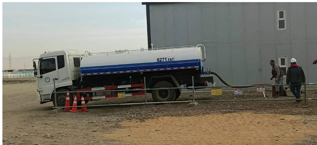
Зураг 4-13 УСУГ-ын зориулалтын тээврийн хэрэгслээр бохир ус соруулж буй байдал
