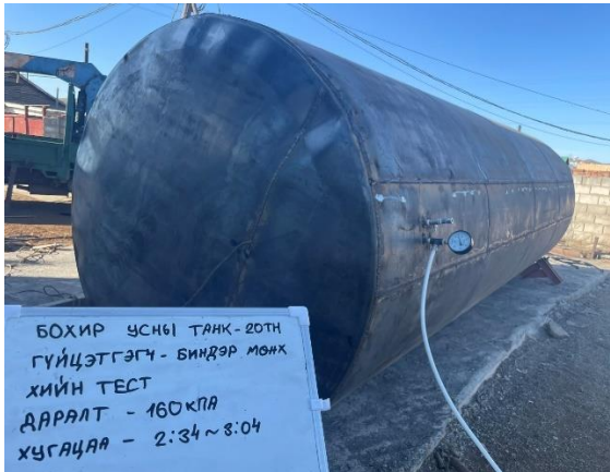
Зураг 4-12 Инженерийн түр оффисын бохир цуглуулах танканд шингэн нэвчүүлэх сорил хийж буй болон танк суурилуулж буй байдал, 2022.10.13
