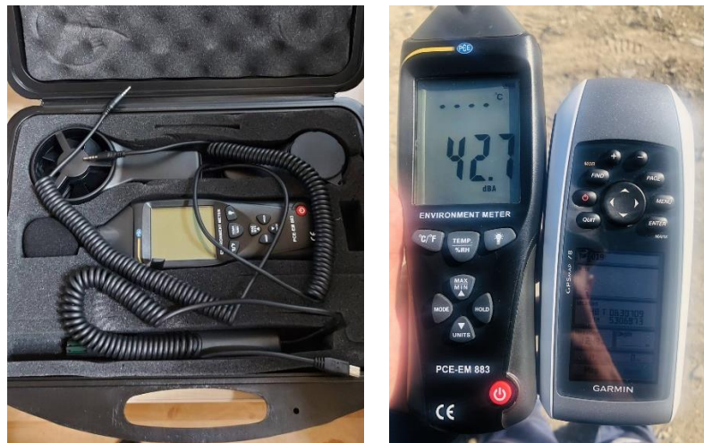
Зураг 4-19 Төслийн талбайд хэмжилт хийж буй зөөврийн дуу чимээ хэмжигч багаж
