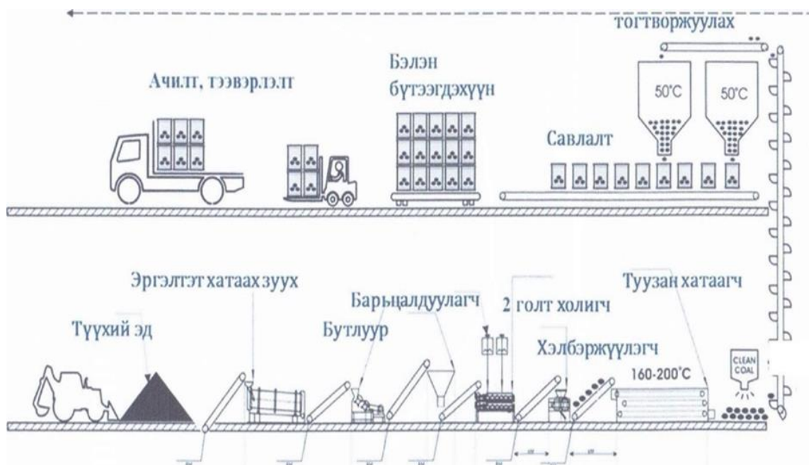
Схем №. 1 Шахмал түлш үйлдвэрлэх технологийн схем
