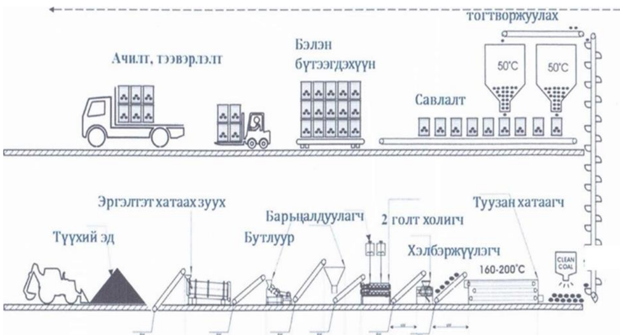
Схем №. 1 Шахмал түлш үйлдвэрлэх технологийн схем
