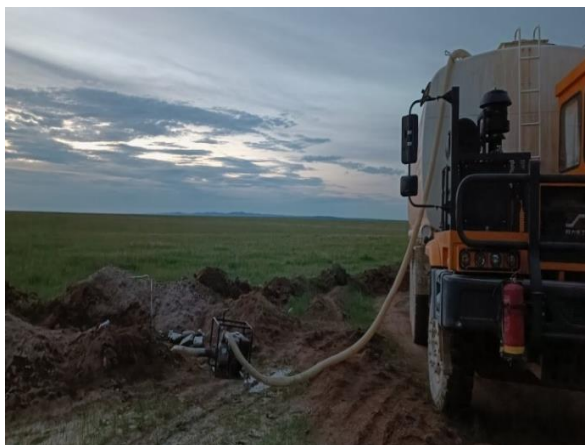
Зураг 11. Уурхайн шүүрлийн усыг тусгай зумп байгуулж хуримтлуулан ашигласан байдал
