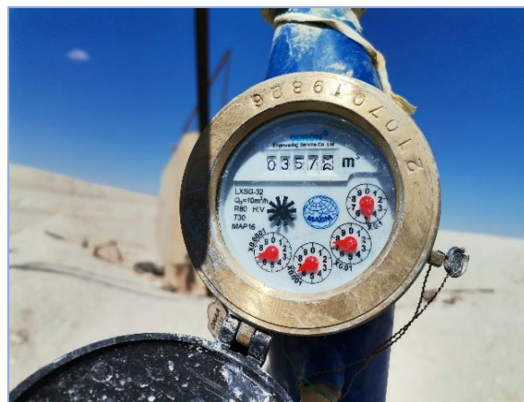
2022.04.27-ны уурхайн технологийн худгийн усны тоолуур баталгаажуулалт /VMP технологийн худаг/
