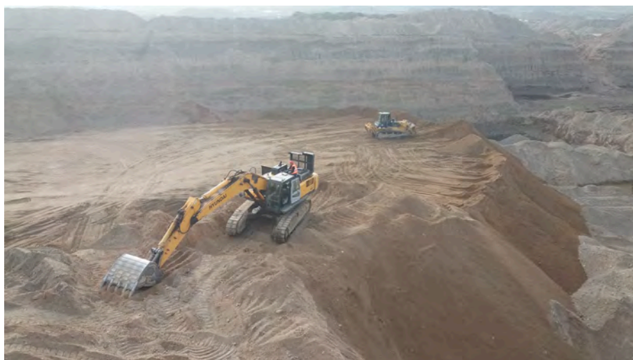
Зураг 15. Дотоод овоолгоор , гадаад овоолгоор техникийн нөхөн сэргээлт хийж буй байдал
