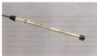
Суурилуулсан автомат түвшин хэмжигч багаж
