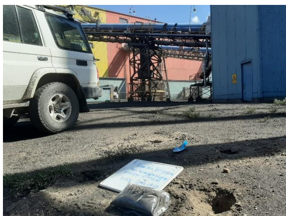
Зураг 12.3.2.1. Хөрсний микроэлементийн шинжилгээний дээж авч буй байдал
