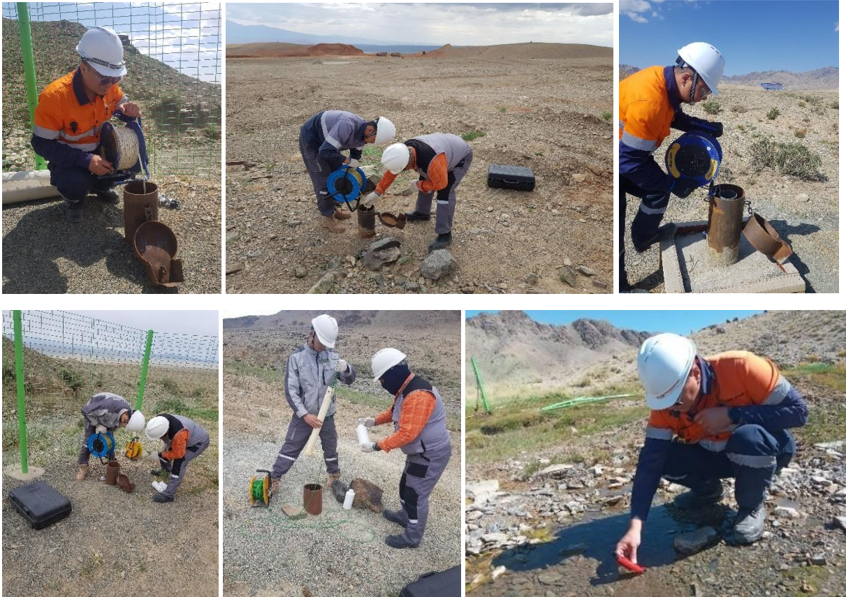
Зураг 20 Ашиглалтын болон ажиглалтын цооногуудад 7 хоног бүрийн усны төвшин хэмжилт
