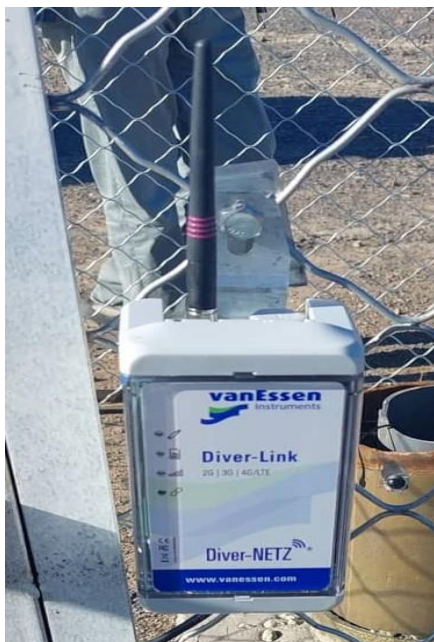
Зураг 20,21 Driver link угсарч суурилуулсан байдал
