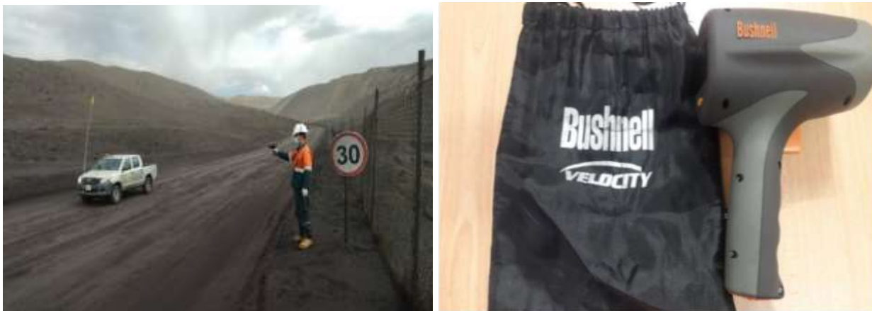
Зураг 10. АНУ-д үйлдвэрлэсэн Bushnell IUW38006 багажаар хурд хэмжигч багаж
