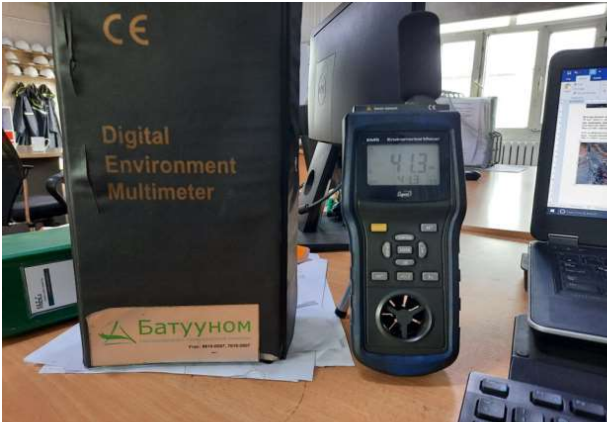
Зураг 65. Дуу шуугианы түвшин, салхины хурд хэмжигч багаж
