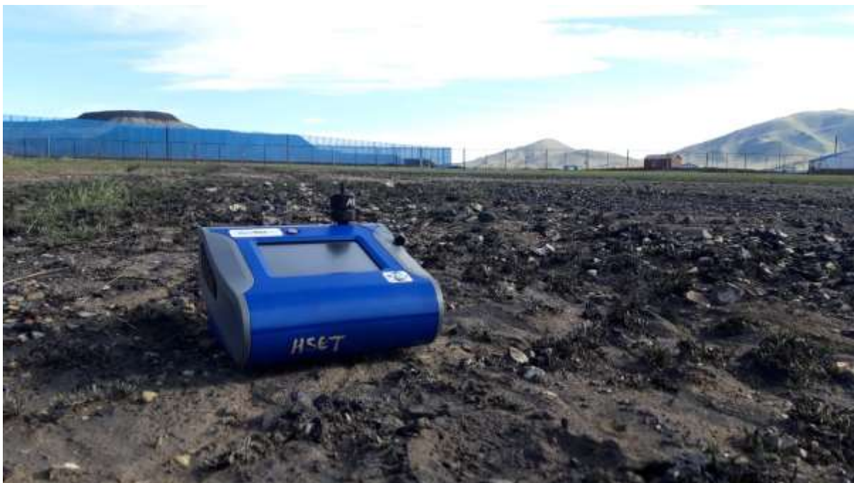
Зураг 64. Тоосонцор хэмжилтийн DustTrack багаж
