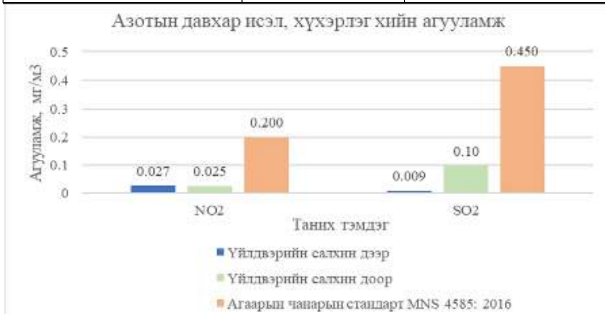
График 2. Үйлдвэрийн салхин дээр болон үйлдвэрийн салхин доороос авсан агаарын чанарын 2 цэгийн азотын давхар исэл, хүхэрлэг хийн агууламж
