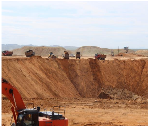
Зураг №11. Дотоод овоолго хэлбэржүүлж нөхөн дүүргэлт хийж байгаа байдал
