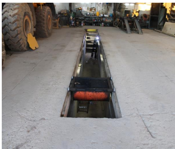
Зураг №5. Засвар үйлчилгээний шалыг цементэлсэн байдал, хаягдал тосны тосгуур
