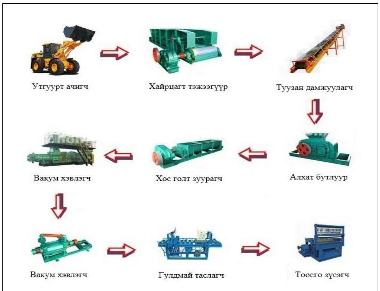
Зураг 1.3. Тоосго үйлдвэрлэлийн тоног төхөөрөмжийн дамжлага схем
