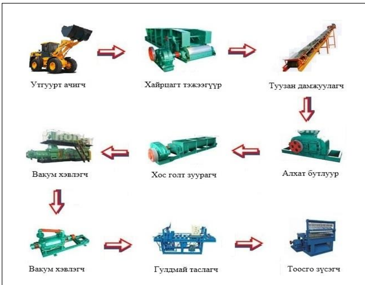
Зураг 1.3. Тоосго үйлдвэрлэлийн тоног төхөөрөмжийн дамжлага схем
