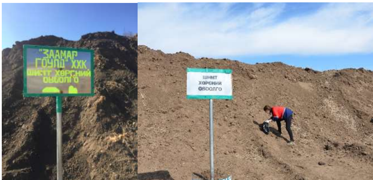
Зураг 15 Шимт хөрсний овоолго ба Шимт хөрснөөс дээж авч буй байдал
