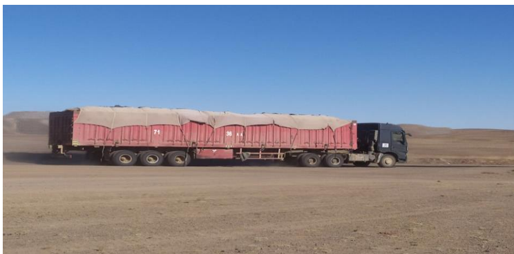
Зураг 11. Гөлтгөнө тээврийн машинууд хучилтаараа бүрэн бүтээж тээвэрлэлт хийж буй байдал.
