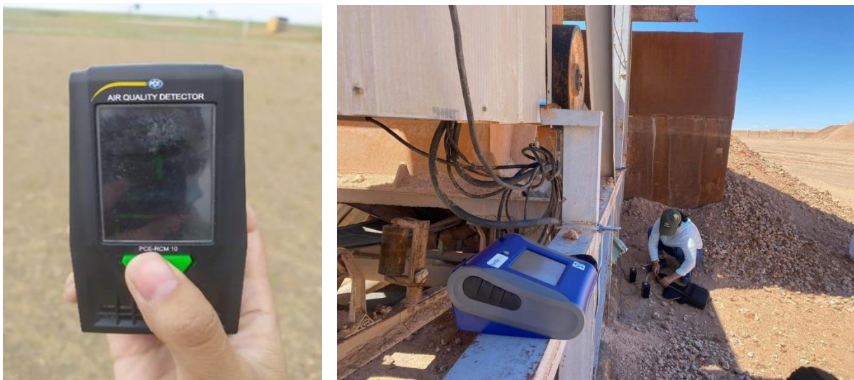
Зураг 36. PCE Air Quality Detector, Dust track багажаар хэмжилт хийж буй байдал
