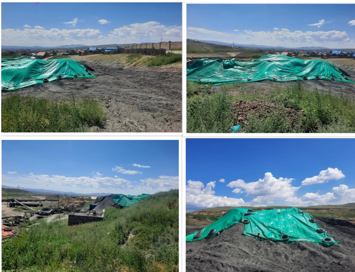
Зураг 5. Төслийн түүхий эд болох нунтаг нүүрс салхинд хийсэж тоосжилт үүсгэхээс сэргийлж хучлага хийсэн байдал
