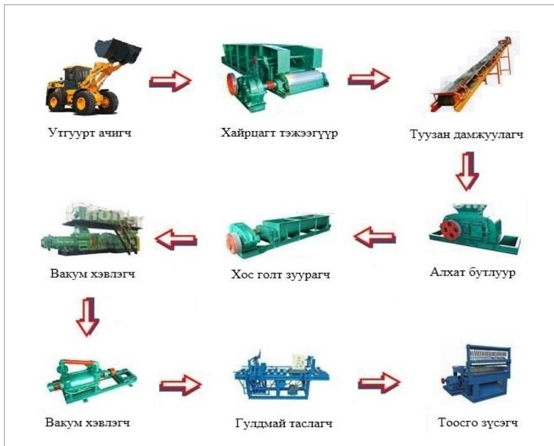
Зураг 2. Тоосго үйлдвэрлэлийн тоног төхөөрөмжийн дамжлага схем
